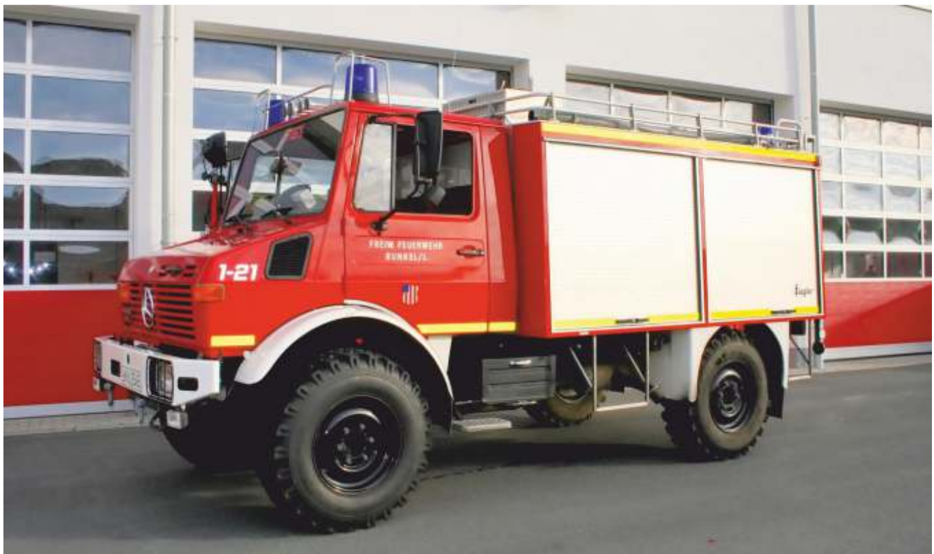
Tanklöschfahrzeug (TLF 8/18) auf einem Mercedes Benz Unimog 1300 L Fahrgestell. Dienstzeit von 1987 bis 2015.
