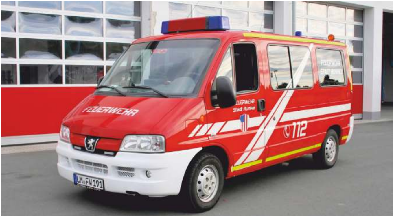
Mannschaftstransportwagen (MTW) auf einem Peugeot Boxer Fahrgestell. Das Fahrzeug wurde als Gebrauchtwagen angeschafft und größtenteils von den aktiven Feuerwehrleuten in Eigenleistung umgebaut. Dienstzeit von 2009 bis 2016.
